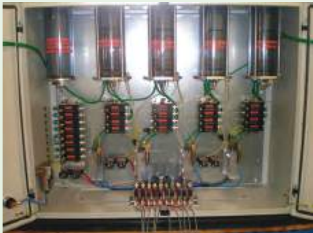
8 pompe per lubrificazione esterna 8 pompe per lubrificazione interna 8 pompe per lubrificazione addizionale
