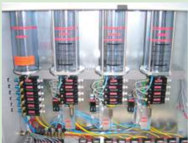
6 pompe per lubrificazione esterna 6 pompe per lubrificazione interna 6 pompe per lubrificazione addizionale
